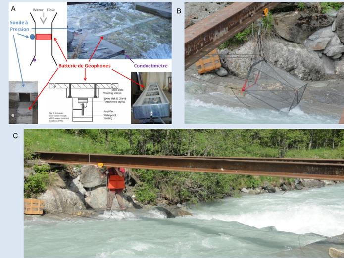
Fig 2 : A) Gauging station B) Sediment trap C) Sampling test
